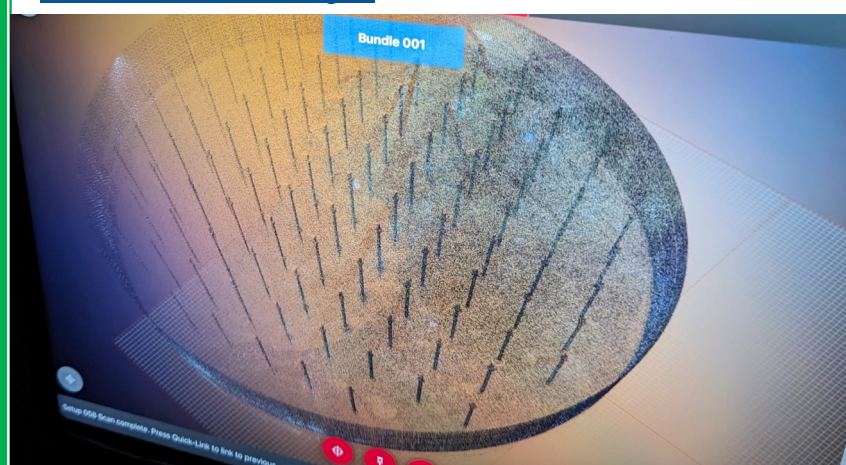
Figura 5: Escaneo de la parte interior del reservorio de 8 millones para obtener un diagnóstico más exacto.
